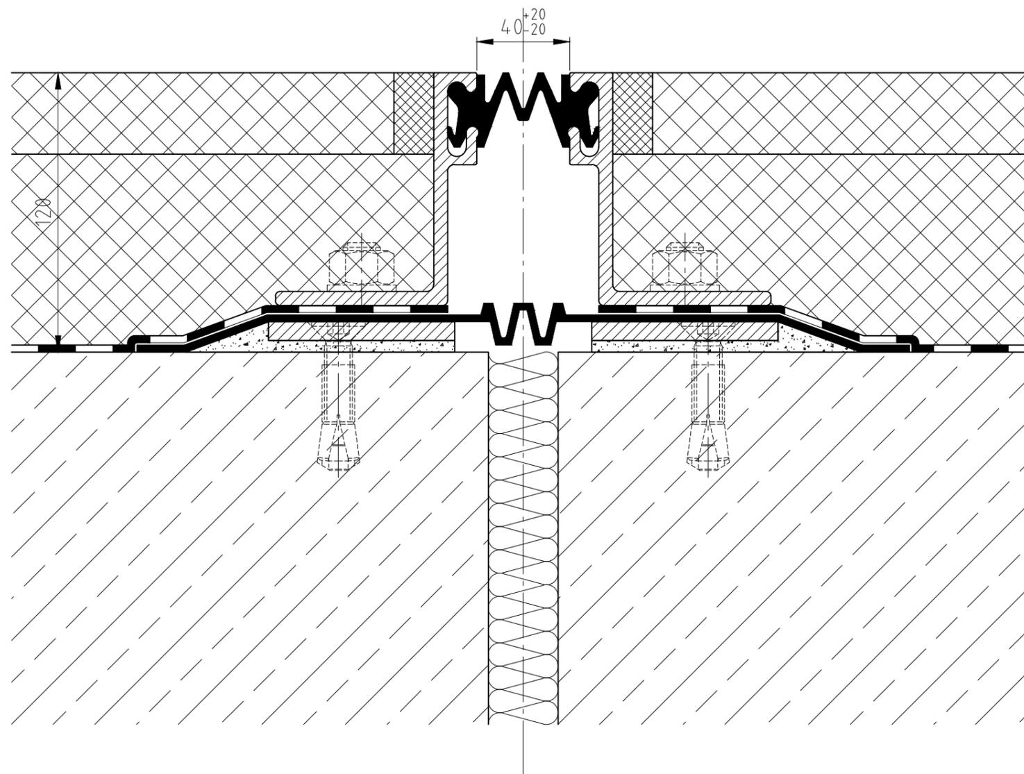
Dehnfugenkonstruktion FK 100 - befahrbar ungedämmt
